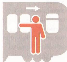
**Опасно** прикасаться к металлическому корпусу вагона и дверям **до отключения высокого напряжения по всему участку**
