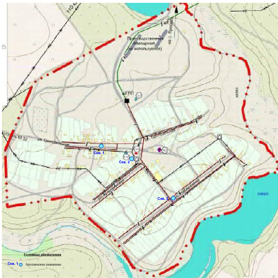
Рисунок 3.2.3 – План водопроводных сооружений п. Домашкины Вершины
